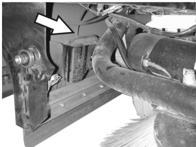
Przyłącze węz do puszkę podciśnieniowej mechanizmu opuszczania miotły bocznej
